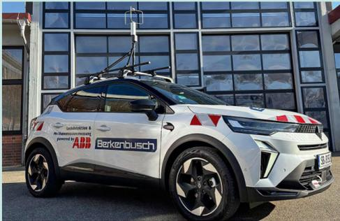
Spezialfahrzeug zur mobilen Methan-Emissionsmessung
